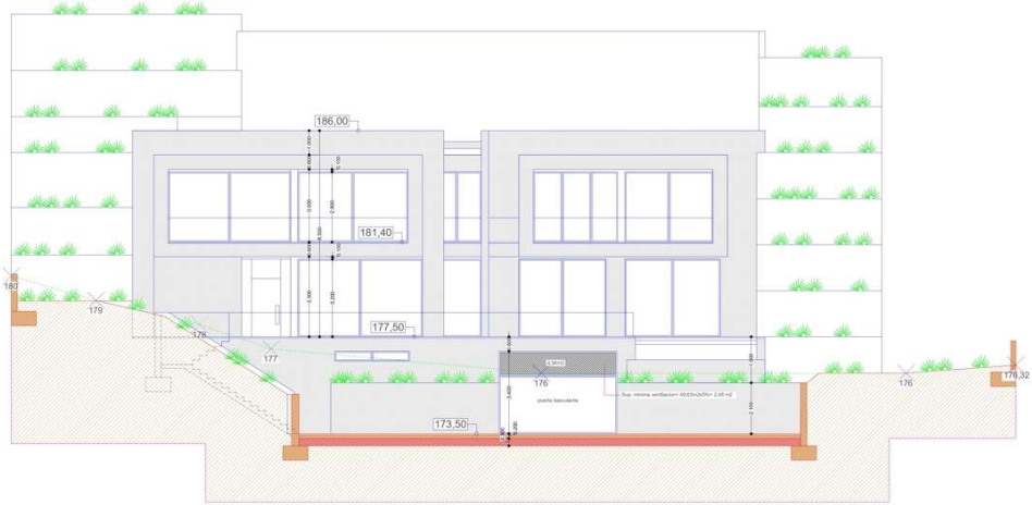
FACHADA PRINCIPAL - SECCION S5-S5* E.1:50
